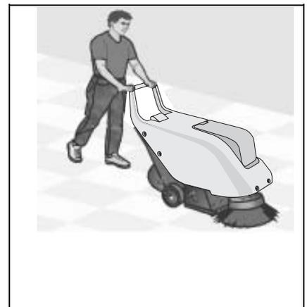
En cas de déchets volumineux pour permettre l'accès à la brosse centrale qui les ramasse, il faut lever la machine en avant en appuyant sur le guidon.
